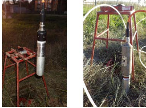
Figure 1.21 Hydrophone avec système d'amplification et géophone 3C avec système d'ancrage (Solgé). Hydrophone with amplification system and 3C geophone with anchoring system (Solgé).
