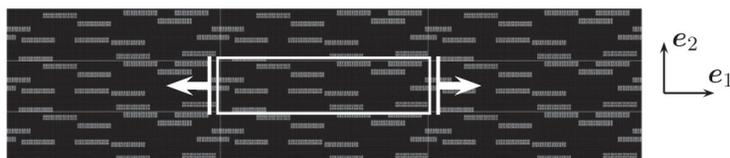
Figure 1.22. Illustration des microstructures considérées pour l'analyse des VER aléatoires et périodiques (20 % d'inclusions), ici reproduction de neuf VER.
