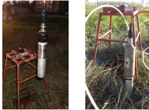
Figure 1.21 Hydrophone avec système d'amplification et géophone 3C avec système d'ancrage (Solgé).
