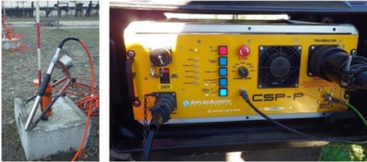
Figure 1.19 Illustration d'une source P : sparker (SolGéo).
