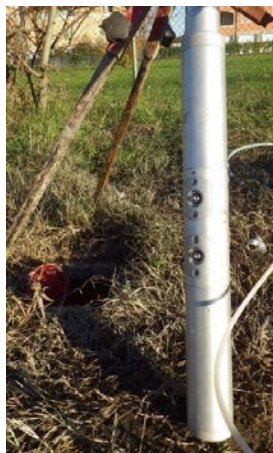
Figure 1.20 Illustration d'une source S mécanique (marteau-enclume Ballard) et électrodynamique (SolGéo, masse déplacée vers le haut ou le bas par un électroaimant).
