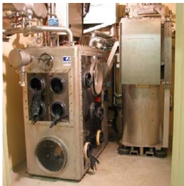
Figure 13 – Installation EPICUR (comprenant notamment un irradiateur) pour l'étude de chimie des PF sous rayonnement.
