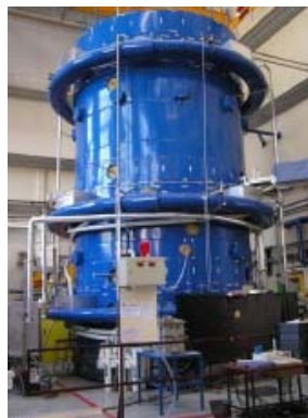
Figure 8 – Installation MISTRA du CEA pour les études sur le risque hydrogène.
