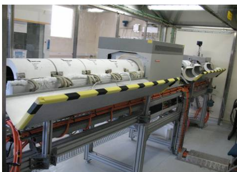
Figure 12 – Réacteur chimique CHIP pour l'étude de la physicochimie des PF dans les circuits.
