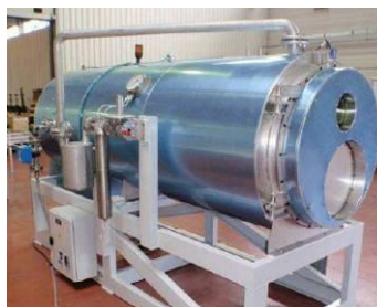
ROBOT CHARLI D'INTERVENTION DANS LES LIPOSO (perçage des rétentions de sodium)
