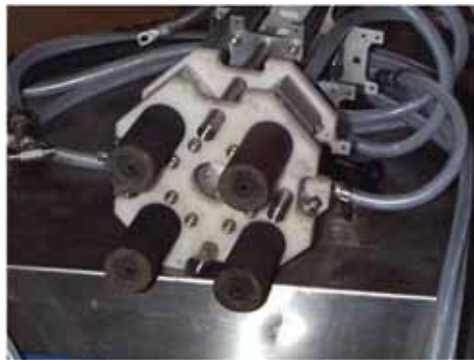
Tête MDM pour retrait multiple des vis de plaques de cloisonnement
